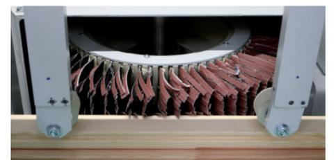
Unterschiedliche Bürstenanordnungen für die teilweise schwer zugänglichen Werkstückgeometrien.
